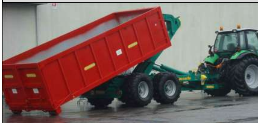
Scarrabili trasportabili da camion o trattori
